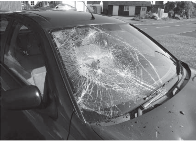
चित्र-2: काँच को अधिक मज़बूत बनाने और उसे तीखे टुकड़ों में टूटने से बचाने के लिए प्लास्टिक का उपयोग किया जाता है। इससे काँच पर सिर्फ दरारें आती हैं और काँच बिखरता नहीं है।
